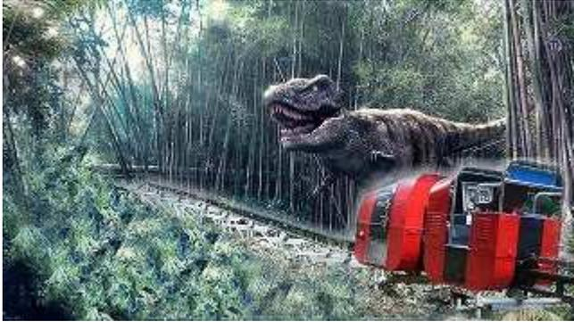
傾斜地での人員輸送の設備としては、ケーブルカーやゴンドラ、チェアーリフトがありますが、これらは、ワイヤーロープに搬器を固定し大型のウィンチを駆動させて走行させる仕組みで索道に分類されます。ケーブルカーは輸送能力があり大量輸送に向いていますが、勾配の変化があると車両は傾いて走行します。また、搬器内に電源がないのでエアコンなど設備はありません。チェアーリフトは風雨に弱くお年寄りや子供の乗車は不向きです。スロープカーは、搬器内に駆動装置があり電源が常に供給されていますので、勾配が変化しても床面を水平にする装置やエアコン、BGM、車内照明などの設置が可能であり、全天候型車両で快適空間での移動が可能です。
